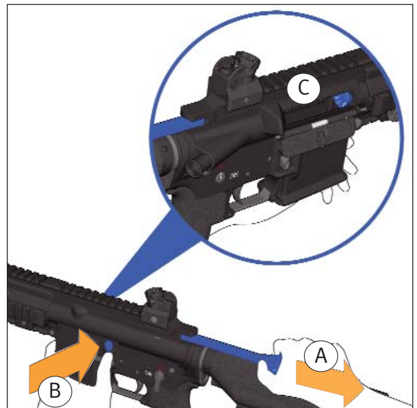
Abb. 23a: Sicherheitsprüfung durchführen
