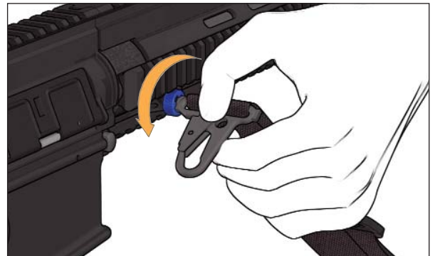
Abb. 39b: Halteschraube für Handschutz lösen
